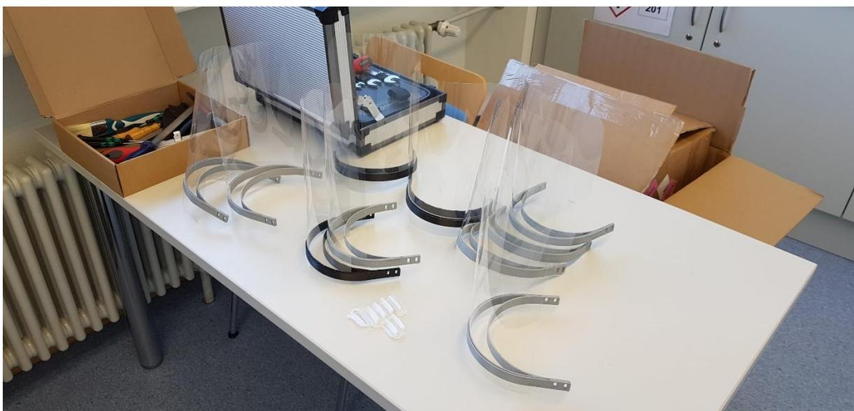
Abb. 3: Montage von Gesichtsbügeln und Overheadfolien
