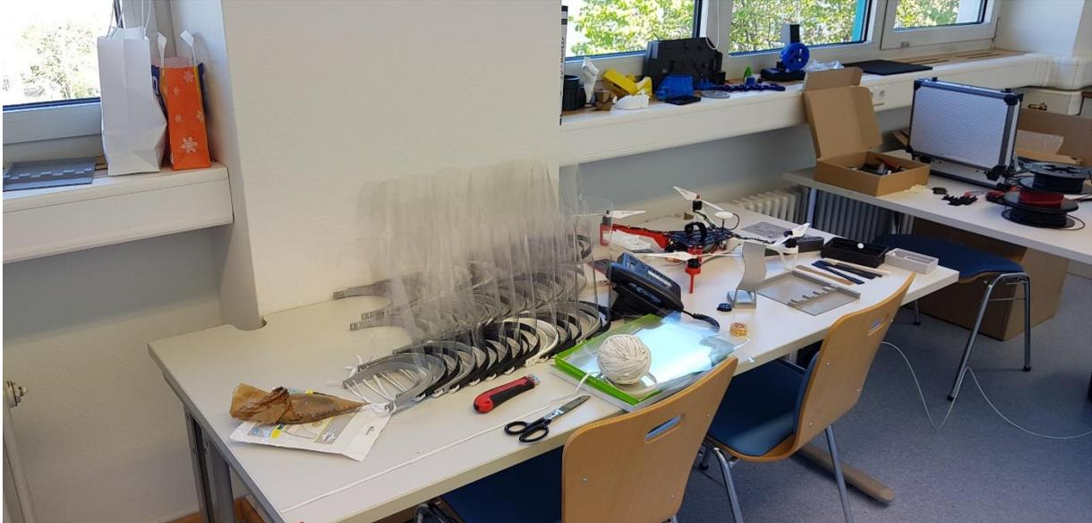
*Abb. 4: Fertig montierte Gesichtsschilde am Montagearbeitsplatz*
